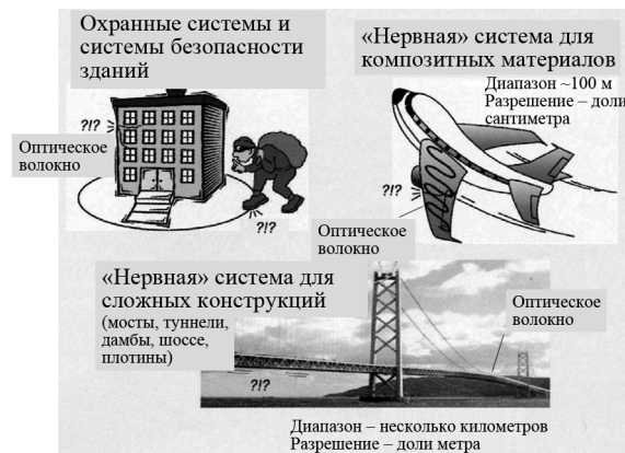
Рис.7. Волоконно-оптические «нервные» системы (К. Notate. Laser & Electrooptics Society Newsletter , 20, 5 (2006)).
