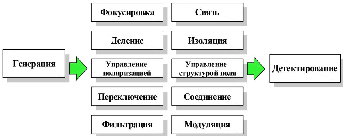
*Рис.1.2. Основные функции элементов интегральных фотонных устройств*
