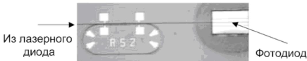
**Рис.1.17. Одиночный круговой резонатор, интегрированный с фотодиодом**
