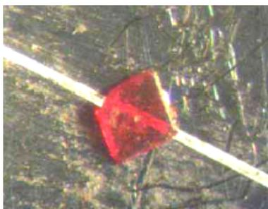
При приложении напряжения к электродам происходит сдвиг фазы проходящего через кристалл света. Для обеспечения амплитудной модуляции кристалл был расположен между двух скрещенных поляризаторов, которые обеспечивали полное гашение света при отсутствии напряжения.
