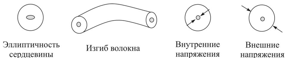
Рис. 1.11. Причины возникновения поляризации (двулучепреломления) в оптических волокнах
