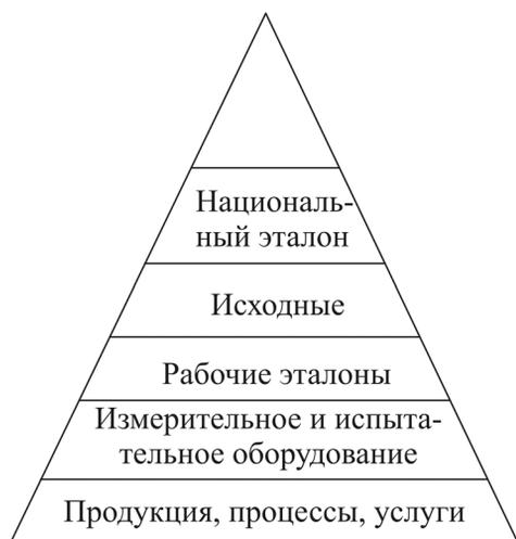
Рис. 3.2. Прослеживаемость измерений
