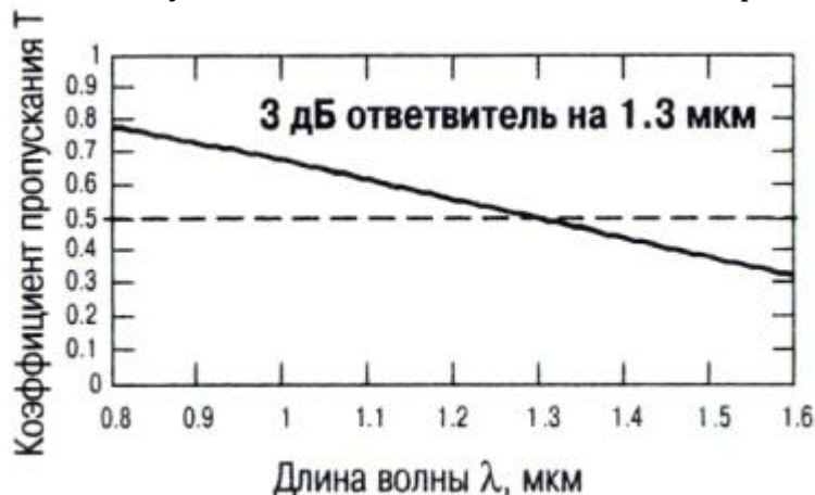
Рис. А.8. Зависимость коэффициента пропускания от длины волны (вытяжка остановлена в точке А)
