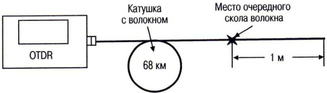
Рис. 3.8. Схема определения разрешающей способности рефлектометра при измерении длины волокна
