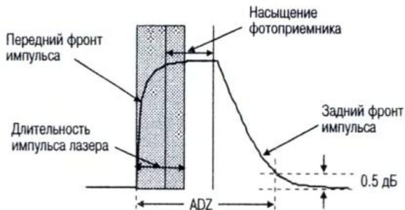
Рис. 2.28. Увеличение ширины мертвой зоны по затуханию (ADZ) при насыщении фотоприемника
