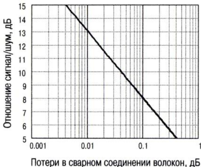
Рис. 2.15. Зависимость требуемой величины отношения сигнал/шум от величины потерь в сварном соединении волокон.
