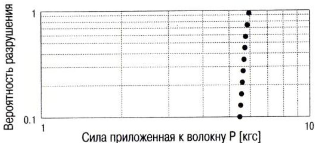
Рис. 4.1. Зависимость вероятности разрушения стандартного одномодового волокна от величины приложенной нагрузки
