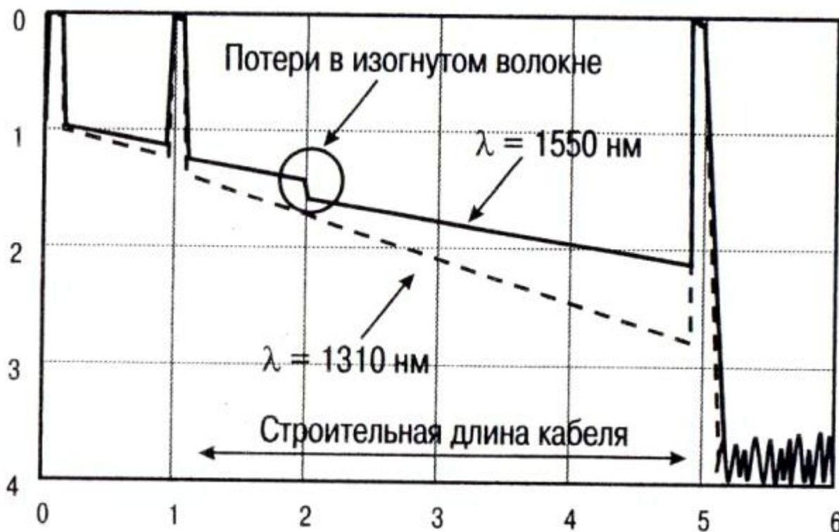
Рис. 3.24. Рефлектограммы, измеренные на длинах волн 1310 нм и 1550 нм
