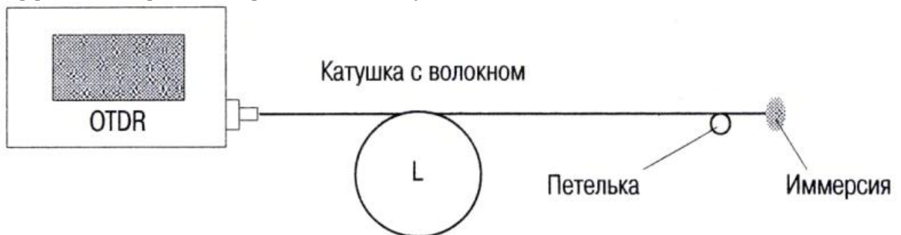
Рис. 3.37. Схема эксперимента по определению зависимости ORL от длины волокна L и коэффициента отражения от торца волокна R_T
