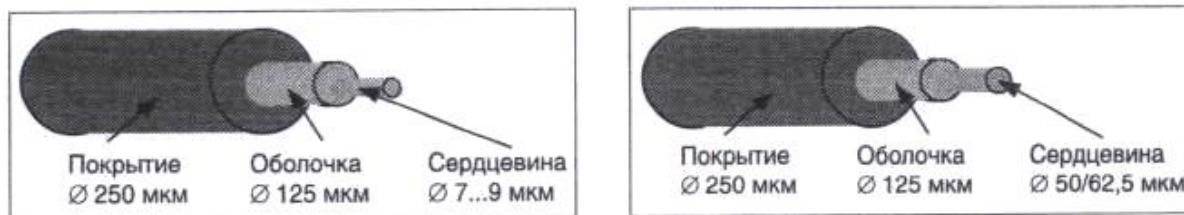
Рис. 1.1. Геометрические параметры одномодовых и многомодовых волокон
