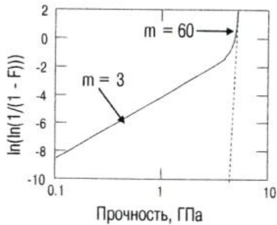
Рис. 4.4. Распределение прочности волокна в координатах \ln(\ln(1/(1-F))) от \ln \sigma
