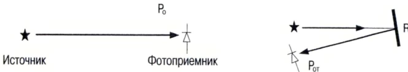
Рис. 3.29. Для нахождения величины коэффициента отражения необходимо выполнить два измерения
