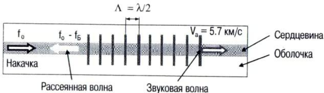
Рис 4.13. Схема рассеяния света на звуковой волне в волокне
