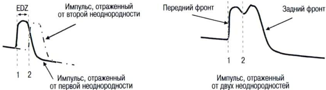
Рис. 2.22. Отражение импульса света от двух одинаковых неоднородностей 1 и 2 расположенных на расстоянии, равном ширине мертвой зоны
