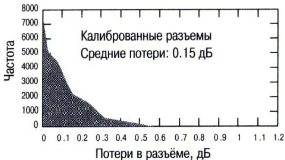
Рис.А.18. Гистограмма распределения потерь вносимых при соединении калиброванных разъемов (любого с любым).
