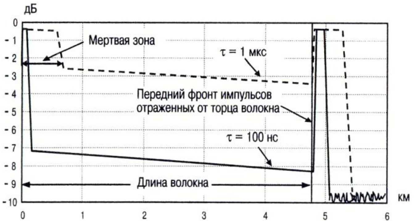
Рис. 3.1. Измерение длины волокна по сигналу отражения от конца волокна
