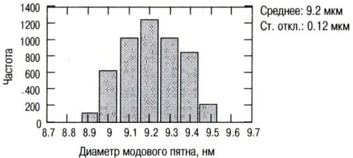
Рис. 1.9. Гистограмма распределения диаметров модовых пятен в SM волокнах компании Hitachi на \lambda = 1310 нм
