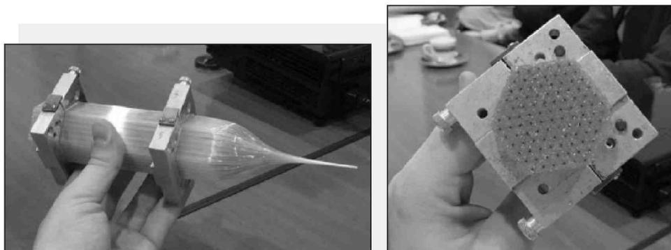
Рис. 4.26. Заготовка ФКС
