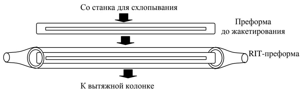
Рис. 4.17. Изготовление преформы RIT – стержень в трубке
