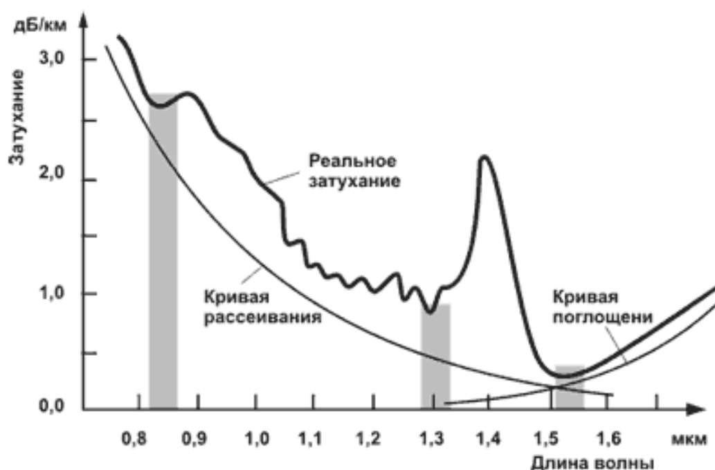
Рисунок 6 – Окна прозрачности оптических волокон [27]
