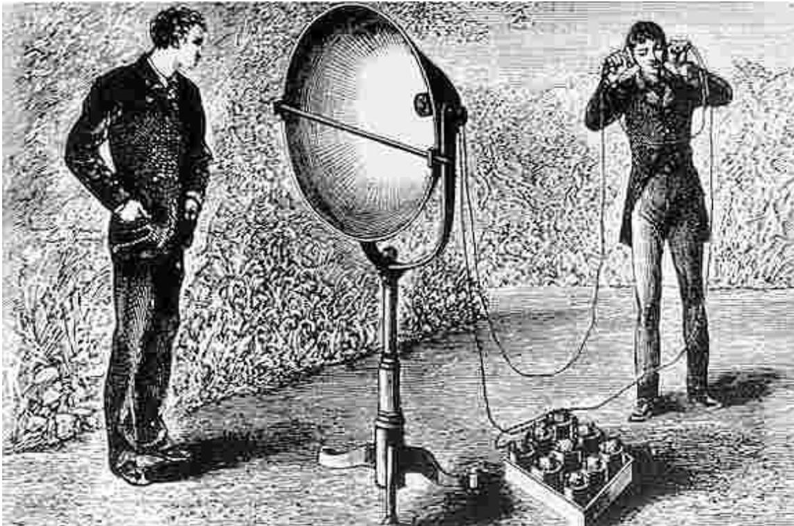
Приемник фотофона с наушниками и электрической батареей оптической телекоммуникационной системы Белла и Тейнтера образца 1880г.
