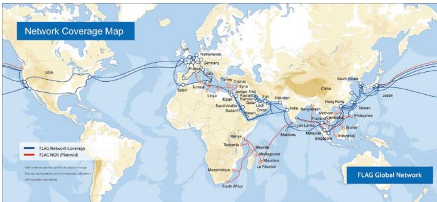
**Fiber Optic Link Around the Globe (FLAG)** – волоконно-оптическая линия связи вокруг Земного шара из одиночного кабеля, по большей части подводного.
